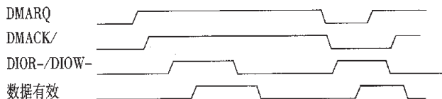
图3 IDE接口时序(多字DMA模式)
