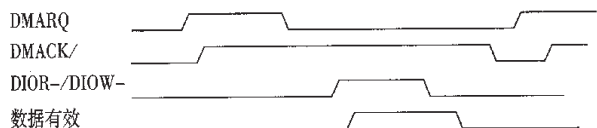
图2 IDE接口时序(单字DMA模式)
